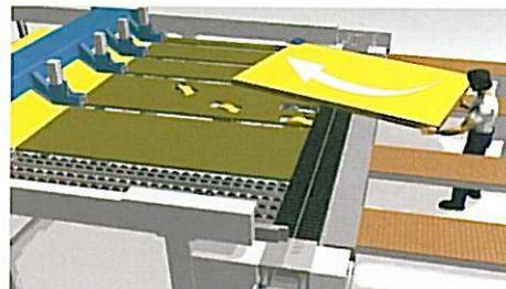
Seconda rotazione di 90° della porzione principale del pacco per riportarlo alla posizione originale, pronto per la sezionatura longitudinale.
