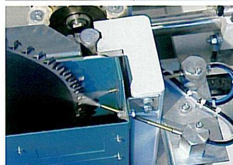
**Sistema di lubrificazione** con doppio spruzzatore aria/liquido, per un raffreddamento della lama al fine di ottenere una maggiore qualità di finitura della superficie tagliata.
