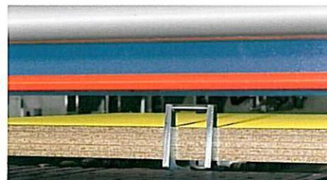
**Nella versione SPT potenti allineatori frontali** effettuano l'allineamento del pacco di pannelli prima che abbia inizio il ciclo di sezionatura longitudinale.
