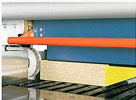
**Aggregato PF** - Gruppo incisore-copiatore per la sezionatura senza scheggiature di barre con bordi già rivestiti, dritti o arrotondati, (post e soft-formati). Il gruppo è applicato separatamente sul lato squadro della sezionatrice.
