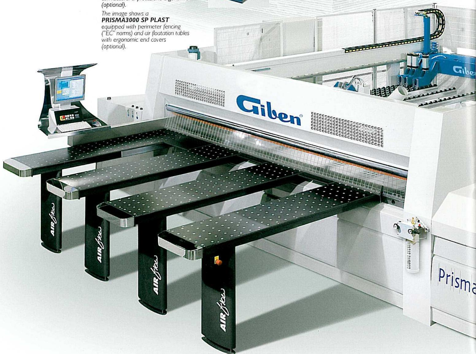
Con la versione **PLAST**, Giben risolve i problemi relativi al taglio di fogli e lastre in materiale termoplastico e termoindurente di qualsiasi natura e spessore. Motore lama controllato da inverter, sistema di raffreddamento e lubrificazione della lama, piani macchina in materiale e costruzione speciale sono solo alcune delle caratteristiche che garantiscono un'alta qualità di taglio.
