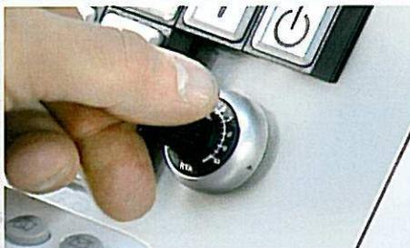
**Motore lama controllato da inverter** per variazione velocità di rotazione al fine di adeguarla ai diversi tipi di materiale da tagliare (optional a richiesta).
