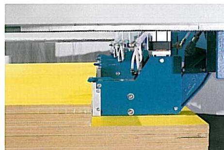
**Nella versione SPT le pinze** sono provviste di una particolare appendice inferiore a scomparsa che consente un prelievo del pacco in ciclo veloce da tavola elevatrice senza l'utilizzo di altri sistemi. Le pinze, con l'appendice inferiore retratta, prelevano il pacco direttamente dalla pila e lo trasferiscono sul piano d'appoggio per l'allineamento frontale. Le pinze bloccano il pacco solo dopo che l'allineamento è stato effettuato.
