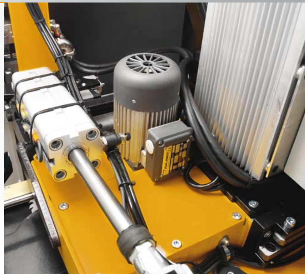
Motore indipendente del gruppo incisore. Independent motor of scoring unit. Motor independiente del grupo incisor. Moteur indépendant du groupe inciseur.
