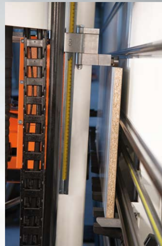
Dispositivo taglio strisce orizzontali. Repeat cutting device of horizontal strips. Dispositivo corte tiras horizontals. Dispositif coupes de bandes repetitive en horizontale.
